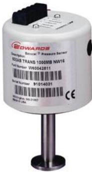
Barocel 600 – это вакуумные мембранные емкостные преобразователи, которые измеряют давление с высокой точностью в пределах рабочего диапазона (4 декады). Принцип действия датчиков основан на преобразовании изменения электрической емкости в электрический сигнал, пропорциональный давлению в вакуумной камере.
