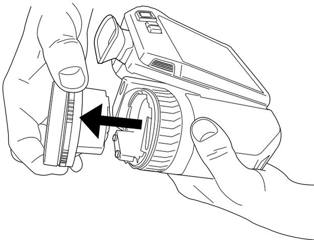
3. Теперь инфракрасный детектор полностью открыт. Не прикасайтесь к этой поверхности. Если на детекторе присутствует пыль, следуйте инструкциям из раздела 23.3 *Инфракрасный детектор*.
