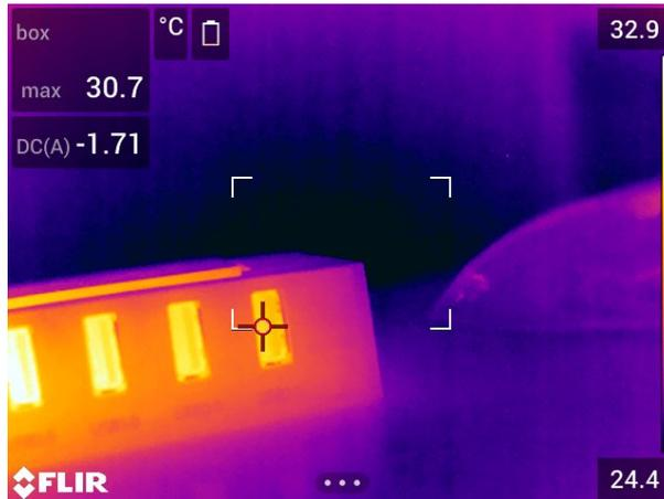
В режиме предварительного просмотра и при редактировании изображения в архиве можно добавить несколько значений от одного датчика FLIR. Последнее добавленное значение отображается под предыдущими значениями. Значение в режиме реального времени обводится пунктирной линией.
