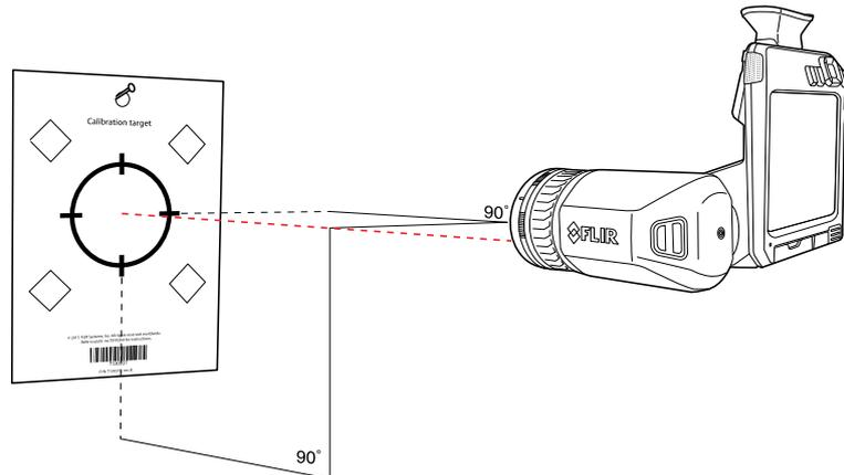
5. Совместите инфракрасное и визуальное изображение в камере (обозначены двумя квадратами на рисунке ниже) с помощью стрелок на сенсорном экране. Теперь комбинация «объектив–камера» откалибрована.
