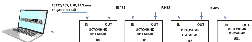
Рисунок 5–21: Подсоединение нескольких источников питания через RS232/485, USB или LAN
