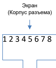
Рисунок 5–1: Назначение выводов входного разъема J4 RS232/485 на задней панели
