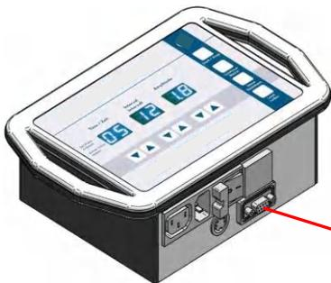
Последовательный интерфейс в нижней части отдельного механизма управления.
