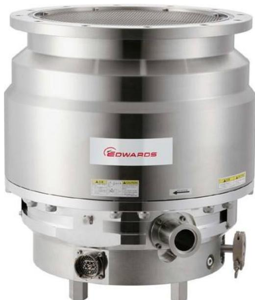
СТР-ХА4503С – это вакуумные безмасляные турбомолекулярные насосы с магнитным подвесом ротора. Они предназначены для сухой высоковакуумной откачки парогазовой смеси из рабочих объёмов. Турбомолекулярные насосы модели СТР-ХА4503С обладают высокой пропускной способностью и способны работать при высокой газовой нагрузке.
