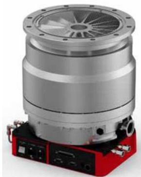
STP-iXA3306C – это вакуумные безмасляные турбомолекулярные насосы с магнитным подвесом ротора. Они предназначены для сухой (безмасляной) высоковакуумной откачки парогазовой смеси из рабочих объёмов.
