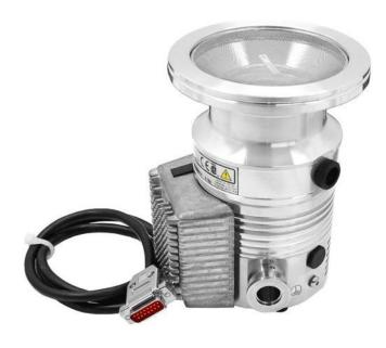
ЕХТ75DX — это гибридный турбомолекулярный насос, объединяющий в себе проверенные технологии нижнего керамического подшипника, сухого магнитного верхнего подшипника и ступень Хольвека. ЕХТ75DX имеет встроенный 24В контроллер, который как параллельно, так и последовательно совместим с ТАG и TIC контроллерами. Насос доступен для заказа с любым из DN40NW, DN63ISO, DN63CF или DN100ISO входным фланцем с быстротой откачки азота до 66 л/с.
