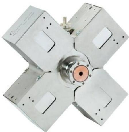
Ионный (магнитоэридный) насос X-WING спроектирован для дифференциальной откачки в ускорительной технике, преимущественно для откачки трактов пучков или фотонных трактов. Насос является модульным, градиент давления зависит от количества насосов (модулей), соединенных последовательно, и размера используемых диафрагм. Одиночный насос позволяет получить разность давлений в 1 порядок. С насосом можно использовать контроллер Gamma Vacuum или контроллер другого производителя.
