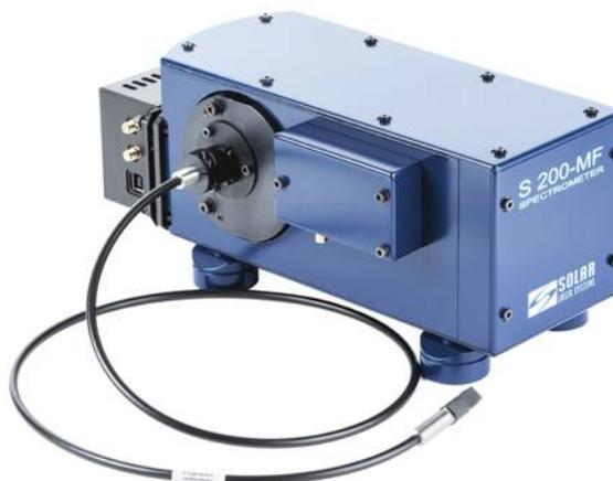
Благодаря инновационной оптической схеме и специально разработанной оптике с коррекцией aberrаций оптический спектрометр S200-MF имеет полную компенсацию астигматизма во всей светочувствительной зоне детектора. Это позволяет подсоединить к входной щели спектрометра многоволоконный оптический кабель и одновременно получать спектры от нескольких световодов. При использовании стандартных датчиков высотой порядка 6 мм число одновременно анализируемых световодов может достигать нескольких десятков.
