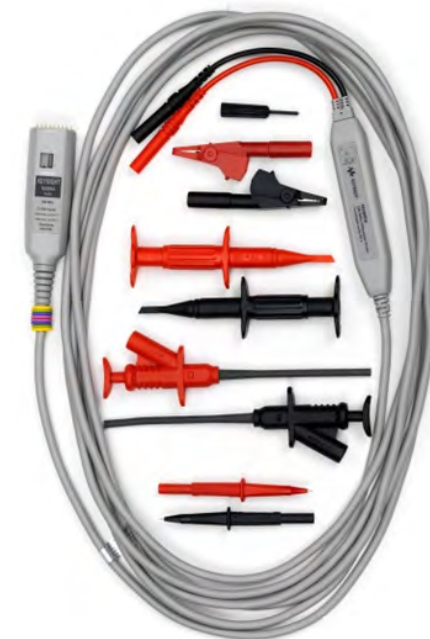
Дифференциальный пробник N2805A с полосой пропускания 200 МГц
