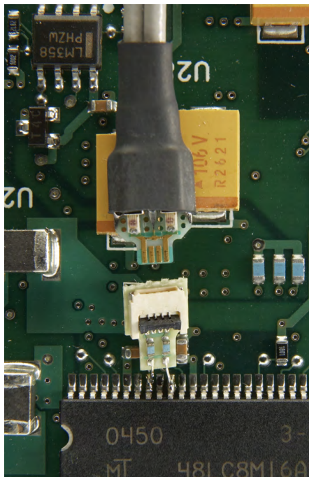
Наконечник пробника InfiniiMax с нулевым усилением сочленения, припаянный к контактам печатной платы.
