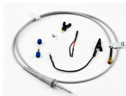
Браузер пробника шин питания N7023A (входит в стандартную комплектацию N7020A или заказывается отдельно)
