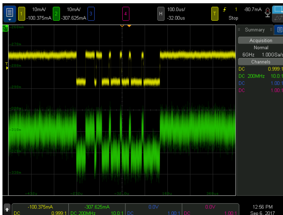
Уровень собственных шумов пробника N7026A (желтая осциллограмма) по сравнению с пробником N2893A (зеленая осциллограмма)
