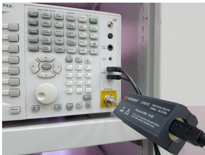
Рис. 4-4 Подключение источника шума с шиной USB к анализатору сигналов
