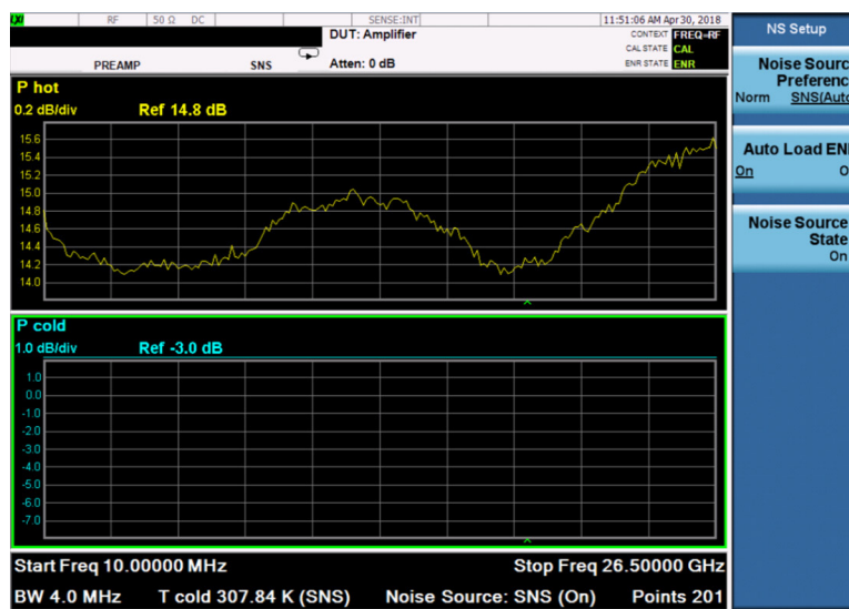
Рис. 4-7 Типичная диаграмма P_{hot} в режиме On
