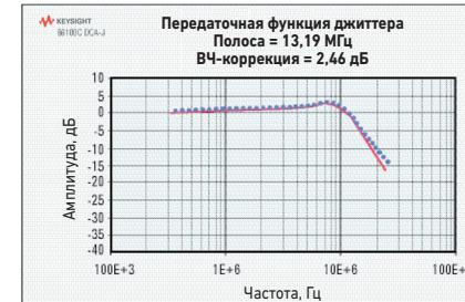
Рисунок 6. Измерение полосы ФАПЧ с помощью осциллографа 86100D DCA-X и прецизионного анализатора сигналов 86108B.
