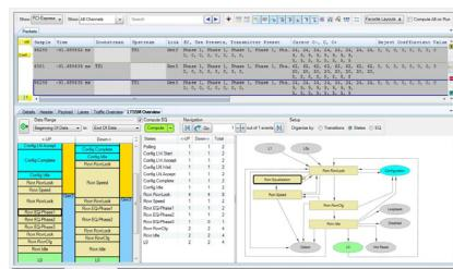
Рисунок 16. Анализ LTSSM сильно упрощается за счёт детального отслеживания каждой смены состояния, которая отображается в представлении линейных состояний, в виде таблицы смены состояний и в виде пузырьковой диаграммы состояний.
