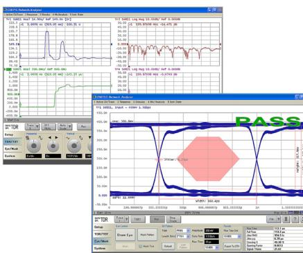
Рисунок 12. Опция TDR для анализатора ENA позволяет выполнять анализ во временной и частотной областях, а также анализ глазковых диаграмм.
