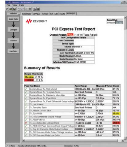
Рисунок 5. ПО измерения электрических параметров PCI Express N5393D быстро генерирует сводный отчёт с осцилограммами и допусками результатов, что позволяет глубже понять имеющиеся проблемы.
