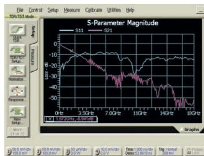
Рисунок 10. S-параметры можно генерировать автоматически с помощью измерительного ПО 86100D DCA-X TDR
