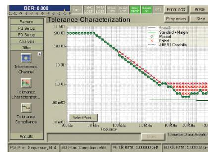
Рисунок 7. Измерение допустимого джиттера с помощью J-BERT N4903B с синусоидальным джиттером от 1 кГц до 300 МГц.
