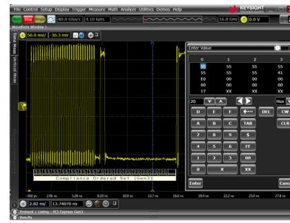
Рисунок 4. Аппаратная система запуска по последовательным сигналам осциллографов серии V находит последовательный набор символов PCI Express Gen 3 длиной 130 бит (PCIe Gen 3 использует схему кодирования 128b/130b).
