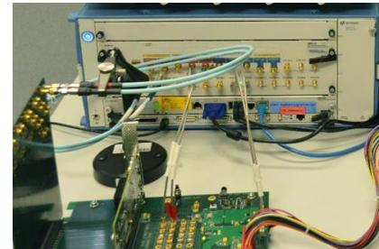
Рисунок 8. Схема измерения допустимого джиттера с помощью J-BERT M8020A.
