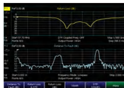
Одновременное отображение обратных потерь и расстояния до неоднородности
