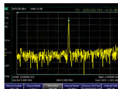
Использование встроенного источника СВЧ-сигналов для тестирования транспондеров
