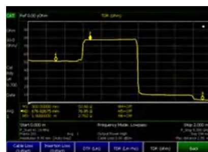
Полное представление о неисправностях с помощью функции TDR
