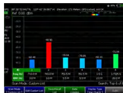
Одновременное сканирование до 20 каналов с помощью опции сканера каналов
