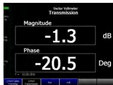
Балансировка кабелей с помощью векторного вольтметра
