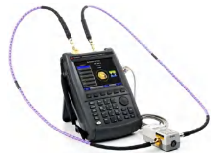
Быстрая и точная калибровка с помощью модуля ECal
