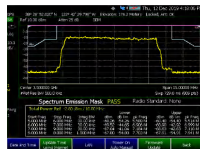
Измерение спектральной маски излучения для сигнала 5G NR FR1
