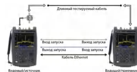
Измерение параметров кабелей большой длины с высоким уровнем потерь с помощью функции ERTA
