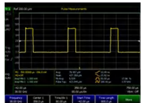
Измерение параметров импульсов с помощью анализатора FieldFox
