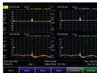
Измерение S-параметров смешанного режима позволяет определить параметры отражения в синфазном и дифференциальном режимах
