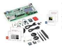
Учебная плата-стенд состоит из самой учебной платы, комплекта датчиков для Интернета вещей, комплекта поддержки беспроводных протоколов связи XBee ZigBee и детальных описаний лабораторных работ и заданий, рассчитанных на 18 часов. Учебная плата-стенд может быть использована студентами для разработки собственных проектов и после завершения программы обучения.
