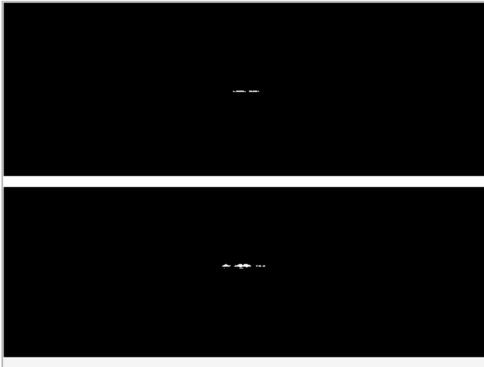
Abb. 3: Beugungsmuster eines Spaltes und eines Doppelspaltes mit gleichen Spaltbreiten oben: Spalt: b = 0,2 \text{ mm} ; unten: Doppelspalt: b = 0,2 \text{ mm} und g = 0,3 \text{ mm}
