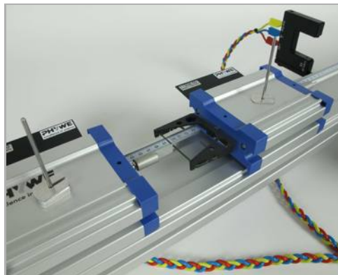
Abb. 7: Abgeschlossene Stöße vor Erreichen der zweiten Lichtschanke
