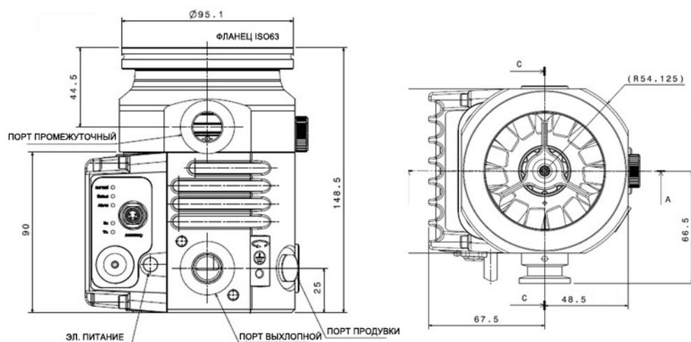
Рис 3. Габаритные размеры насоса /H DN63ISO-K
