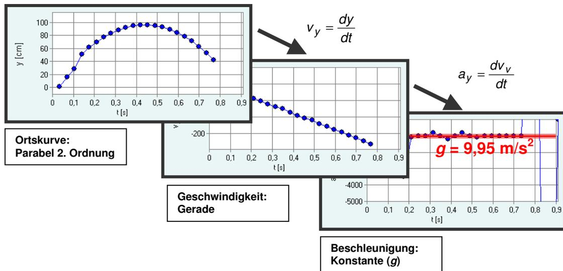
**Abb. 3:** Analyse eines senkrechten Wurfs nach oben (gleichförmig beschleunigte Bewegung)
