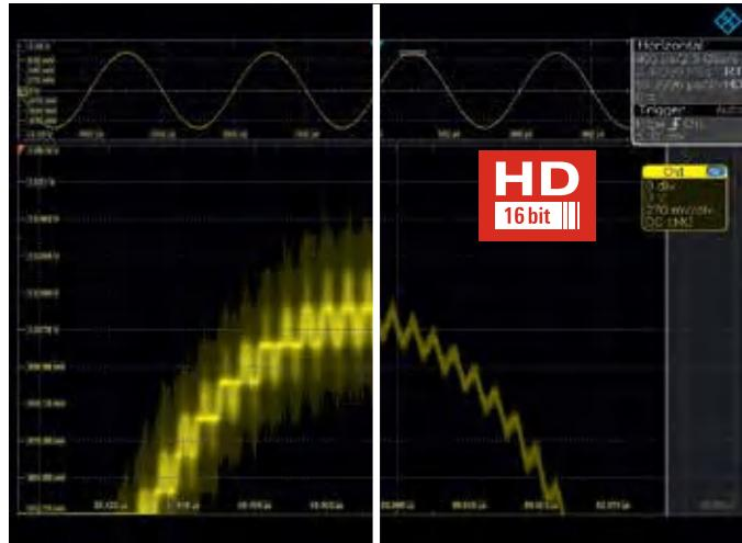
Режим высокой четкости (режим HD) повышает вертикальное решение осциллографа R&S®RTE до 16 бит. Осциллограммы становятся более четкими, отображая более подробную информацию о сигнале, которая в противном случае была бы замаскирована шумом.
