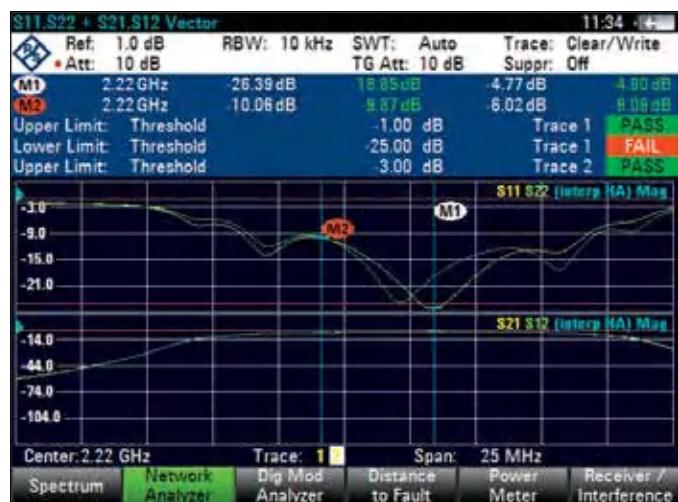
Режим векторного анализатора цепей: для тестирования и снятия характеристик антенн и потерь в кабеле, а также измерений расстояния до места повреждения. Поддержка двухпортовых измерений передаточных характеристик.
