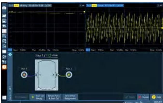
Поддержка модуля автокалибровки: для удобной автокоррекции систематической погрешности используются модули автоматической калибровки. Для обеспечения еще более высокого быстродействия доступна одношаговая автокалибровка.
