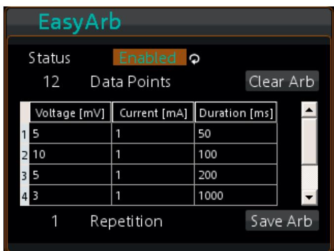
Удобные функции для специальных применений: функция EasyArb позволяет программировать последовательности "время/напряжение" или "время/ток".
