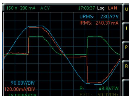
Осциллографма: нагрузка с управлением фазовым углом.
