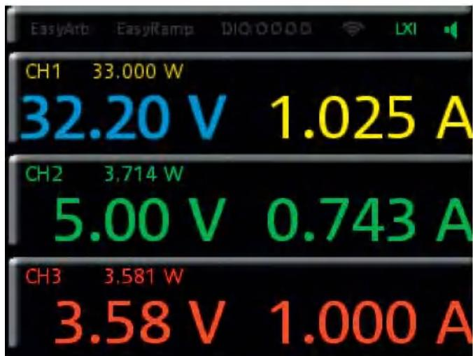
Различные рабочие состояния отмечаются цветом: режим постоянного напряжения обозначается зеленым цветом, режим постоянного тока – красным цветом, неактивные каналы показаны желтым цветом, синий цвет указывает на то, что канал находится в режиме настройки.
