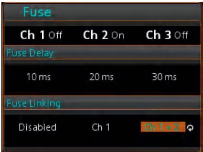
Пользователи могут настроить источник питания таким образом, чтобы при достижении предела в одном канале отключались сразу все каналы. Или оставался рабочим только один канал.
