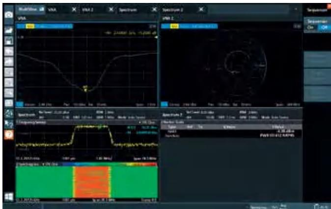
Функция MultiView обеспечивает удобное представление всех активных режимов прибора R&S®ZNL. Здесь можно видеть комбинацию анализатора спектра и анализатора цепей. В данном представлении все режимы обновляются последовательно.
