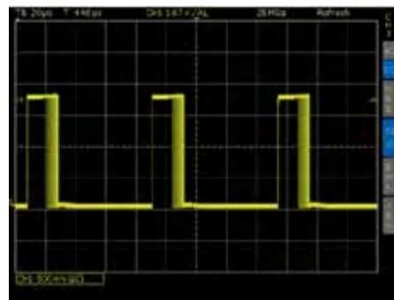
Широтно-импульсная модуляция (ШИМ).
