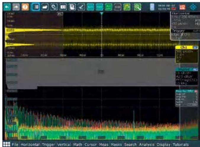
Осциллографы R&S®RTE оснащены встроенной функцией спектрального анализа для проведения параллельного анализа до четырех сигналов. Результаты могут быть со-поставлены во временной и частотной областях. Доступны такие функции анализа, как спектrogramма (с опцией R&S®RTE-K18), тестирование по маске и список пиков.
