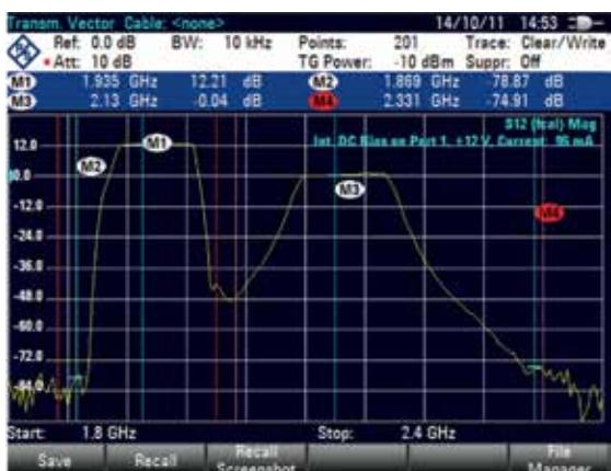
Поддержка двухпортовых измерений передаточных характеристик.
