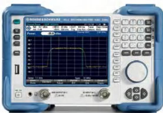
Следящий генератор для скалярных измерений параметров передачи.
