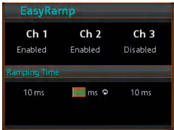
Удобные функции для специальных применений: функция EasyRamp имитирует рабочие условия с управляемым нарастанием напряжения питания для предотвращения резких скачков напряжения.
