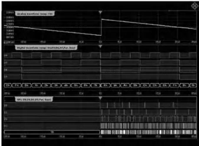
Благодаря опции R&S®RTE-B1 любой прибор R&S®RTE может быть превращен в осциллограф смешанных сигналов с 16 цифровыми каналами. В данном примере показан пи-лообразный сигнал 4-разрядного АЦП с аналоговыми и цифровыми каналами, сопоставленный с шиной SPI, управляющей АЦП.
