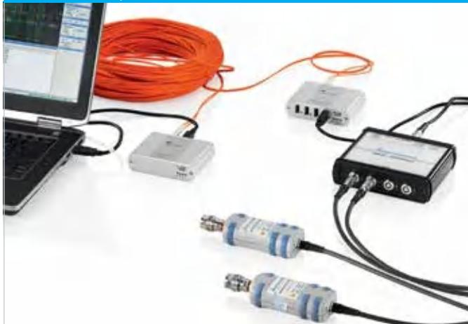
Датчиками мощности можно управлять с использованием базового блока R&S®NRP2 либо непосредственно с ноутбука/ПК. Они также совместимы с многочисленными генераторами сигналов и анализаторами спектра и цепей компании Rohde & Schwarz. Кабель пассивного USB-адаптера R&S®NRP-Z4 — это все, что требуется для подключения датчиков к ноутбуку/ПК.
