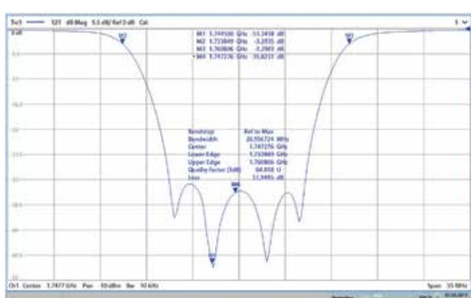
Векторный анализ цепей: автоматическое снятие характеристик фильтра с помощью расширенных маркерных функций: все важные значения за один шаг.
