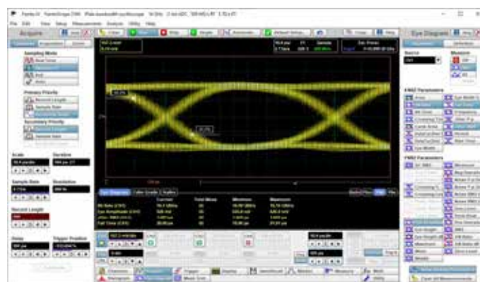
Рис. 7 Глазковая диаграмма 16 Гбит/с на осциллографе АКІП-4139/2
