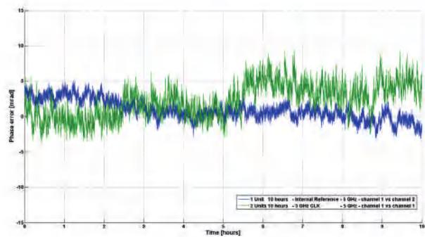
MCSG: фазовая стабильность на 5 ГГц Между каналами в одном устройстве (синий) Между каналами отдельных устройств (зеленый)
