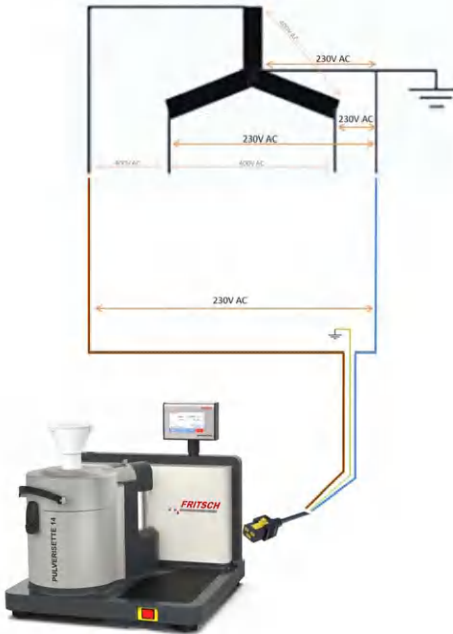
Рис. 2: 3 фазы, 4 провода 230/400 В заземлены
