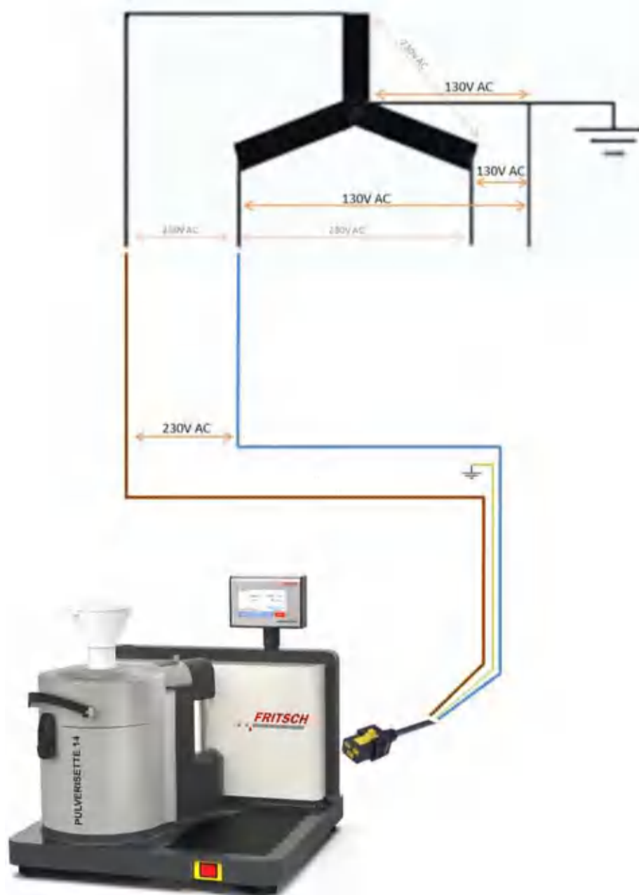
Рис. 3: 3 фазы, 4 провода 130/230 В заземлены
