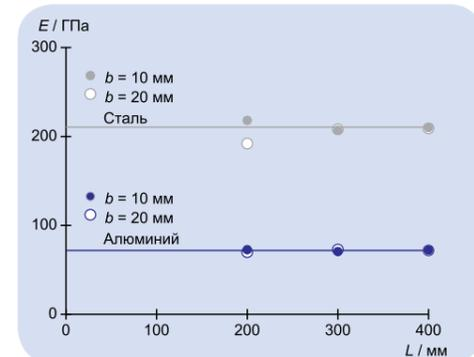
Рис. 4. Модуль упругости стали и алюминия
