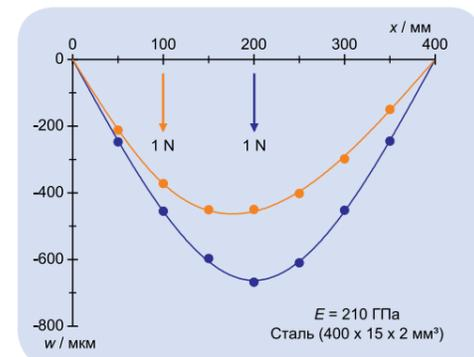
Рис. 1. Измеренный и расчетный профиль деформации для нагрузки, действующей в центре, и смещенной от центра нагрузки
