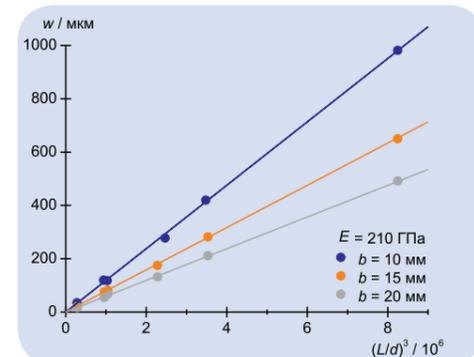
Рис. 3. Зависимость деформации от соотношения  $(L/d)^3$
