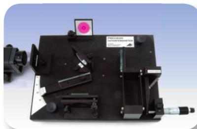
Стеклопластина на пути луча интерферометра Майкельсона.
