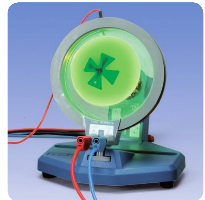
Рис. 2: Поворот электронной тени за счет отклонения электронов в магнитном поле, ориентированном вдоль оси
