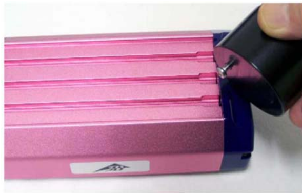
Рис. 22. Установка дополнительного груза в канавку на верхней стороне тележки
