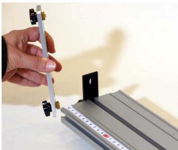
Рис. 16. Установка держателя для светового барьера в канавку на боковой стороне дорожки
