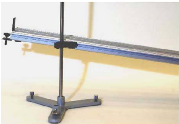
Рис. 20. Собранный и установленный зажим для стоек в канавке на боковой стороне дорожки
