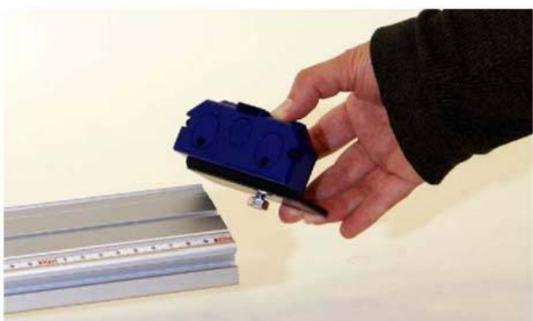
Рис. 14. Установка концевой упора с держателями магнитов в канавку на верхней стороне дорожки
