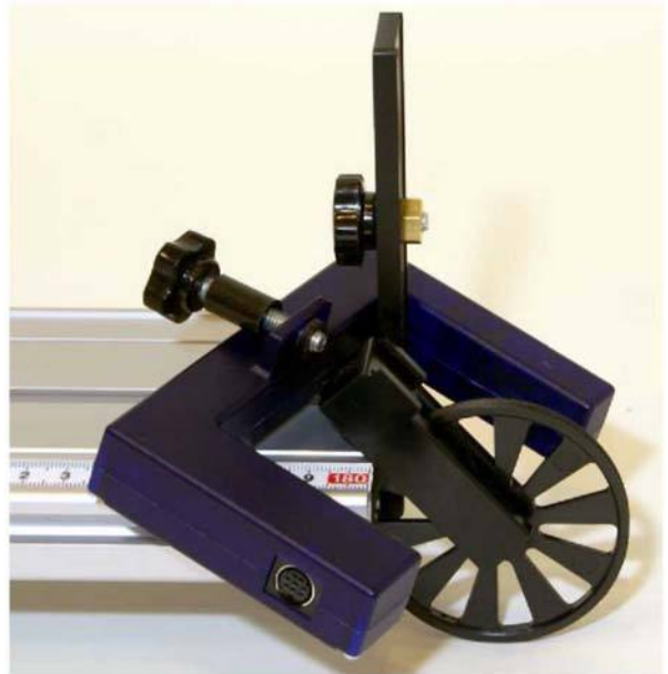
Рис. 11. Установка блока на световой барьер
