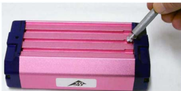
Рис. 24. Установка контактного выключателя в канавку на верхней стороне тележки
