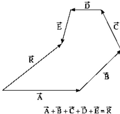
Daher befindet sich ein Körper, auf den mehrere Kräfte wirken, im Gleichgewicht, wenn sich die Kräfte als geschlossenes Polygon darstellen lassen. Die Vektorsumme der individuellen Kräfte ist gleich Null und deshalb ist die Resultierende auch Null.
