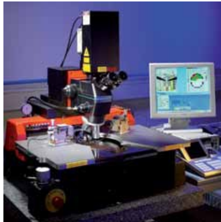
Анализ на отказ на установке PA200 с установленным лазерным резчиком.
