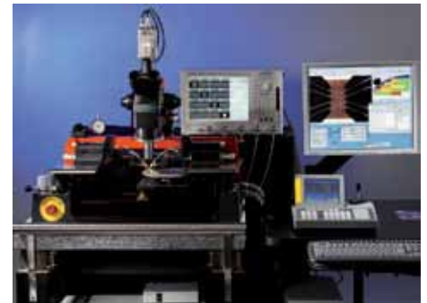
Автоматические многопортовые измерения кремниевой пластины на установке PA200 и комплексе VNA.
