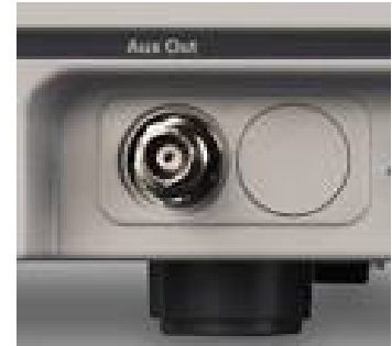
Рисунок 21. Дополнительный выход (Aux Out) используется в процессе калибровки каждого из каналов — к нему подключаются датчики и адаптер пробника. Соединительный кабель входит в комплект поставки базового блока, поэтому можно немедленно приступить к пользовательской калибровке
