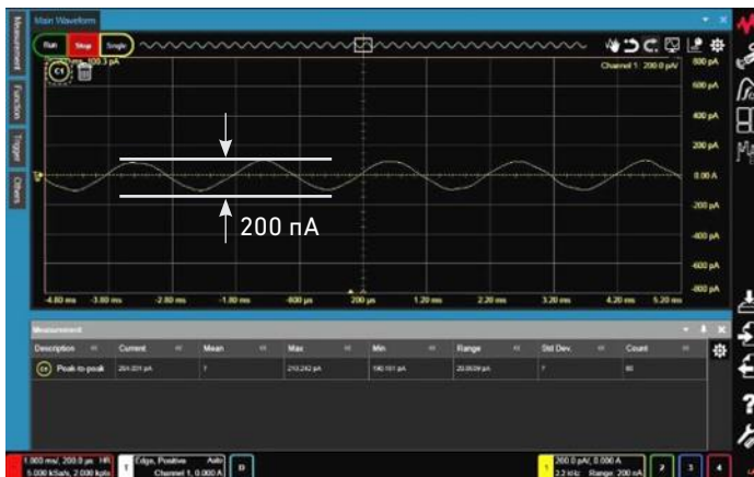
Рисунок 4. Пример измерения крайне низкоуровневых токов: кривая тока с полным размахом 200 пА
