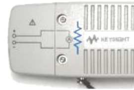
Рисунок 28. Последовательный резистор малого номинала
