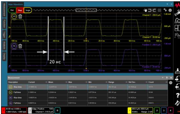
Рисунок 9. Возможность с легкостью измерять переходные токи с шириной импульса менее 100 нс, что поможет при оценке и анализе таких двухполюсных элементов, как PRAM, ReRAM, MRAM и др.
