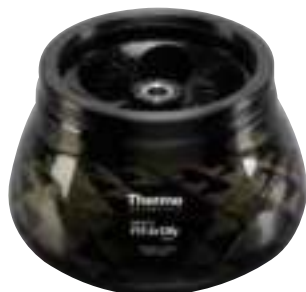
Угловой ротор Fiberlite F15-6x100y, 25°, R макс. 98 мм
