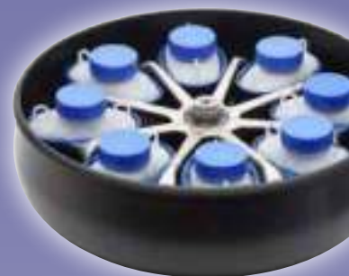
Ротор емкостью 8 x 2000 мл 3900 об/мин 5374 g
