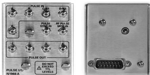
Адаптер импульсного ввода/вывода (N1966A) упрощает подключение
