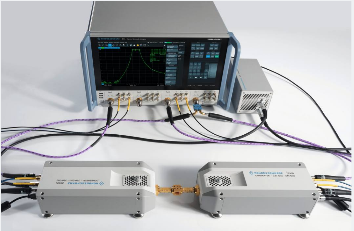
Установка для измерений в миллиметровом диапазоне, состоящая из анализатора R&S®ZNA43 и двух преобразователей миллиметрового диапазона WM-864 R&S®ZC330
