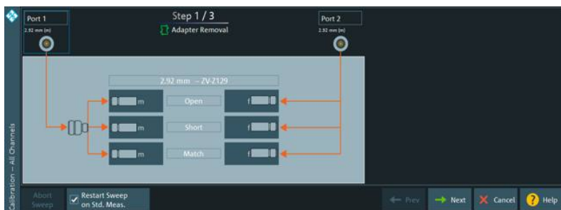
Понятные диалоговые окна помогают пользователю шаг за шагом пройти процесс калибровки с удалением адаптера для калибровки ИУ со смешанными разъемами на входе и выходе.
