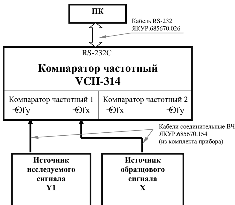
Рисунок 6.3 – Схема электрическая структурная при измерениях одноканальным методом “двух генераторов”
