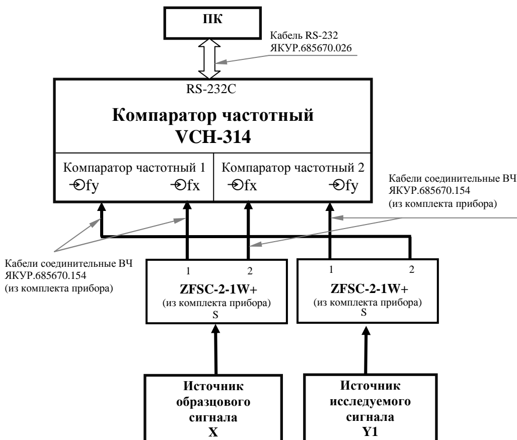
Рисунок 6.4 – Схема электрическая структурная при измерениях методом «двух генераторов»
