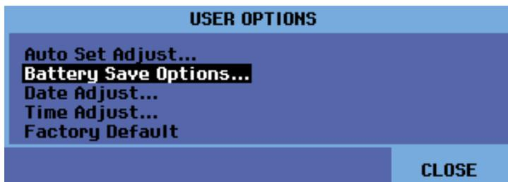
4. Для параметра Instrument Auto-OFF (автоотключение прибора) выберите значение **5 minutes** (5 минут).
