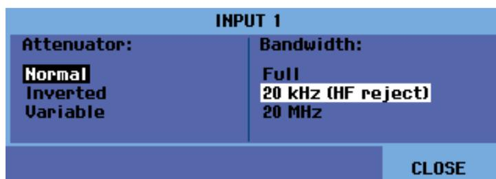
**ПРИМЕЧАНИЕ.** Для подавления шума без ограничения полосы пропускания воспользуйтесь функцией усреднения или отключите параметр *Display Glitches* (отображение глитчей). (См. стр. 2-19, Сглаживание осциллограмм с помощью усреднения.)
