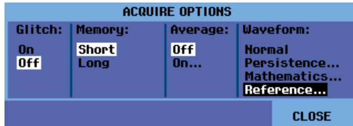
4. Укажите для параметра Reference (опорная) значение **On** (вкл.), чтобы отобразить опорную осциллограмму. Опорная осциллограмма может представлять собой:
