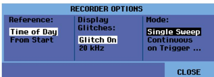
4. Нажмите функциональную кнопку под пунктом меню **RECORDER** (ЗАПИСЬ) и выберите команду **RUN** (ЗАПУСК), чтобы начать запись в режиме однократной развертки.
