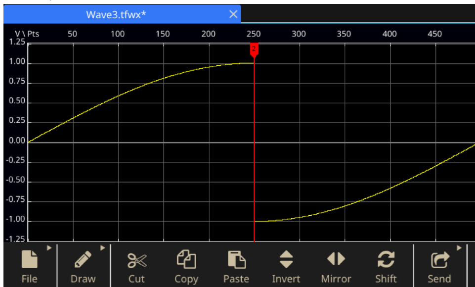
Рисунок 133: Инверсия сигнала в ArbBuilder
