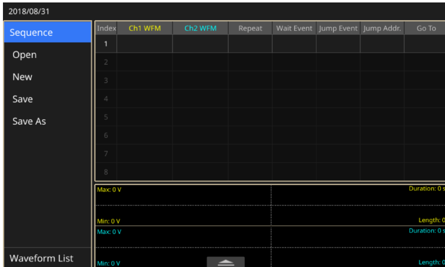
Рисунок 22: Экран последовательности сигналов одноканального генератора
