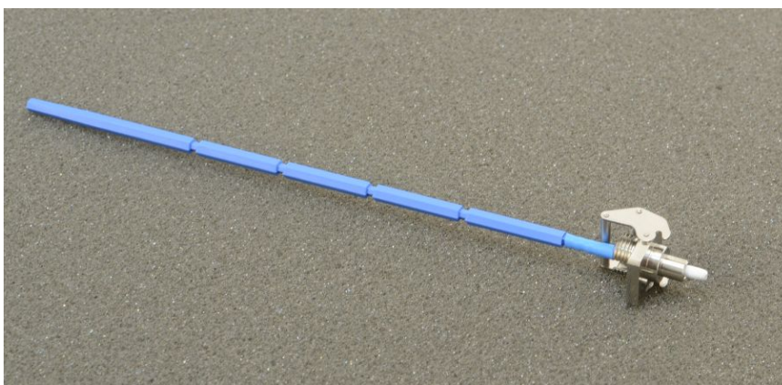
Рис. 11: Чистка соединителя JAE
