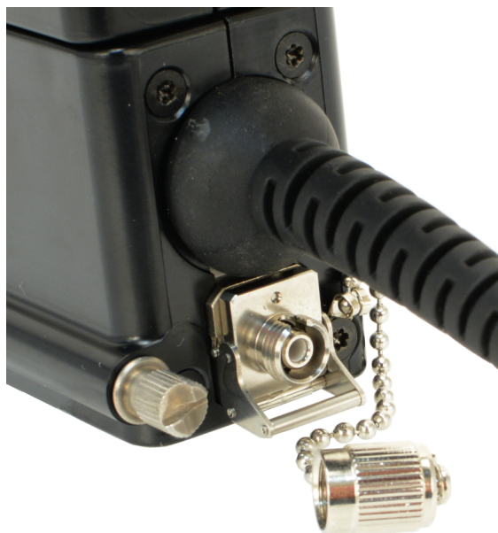
Рис. 9: Снятие металлического пылезащитного колпачка с оптического соединителя
