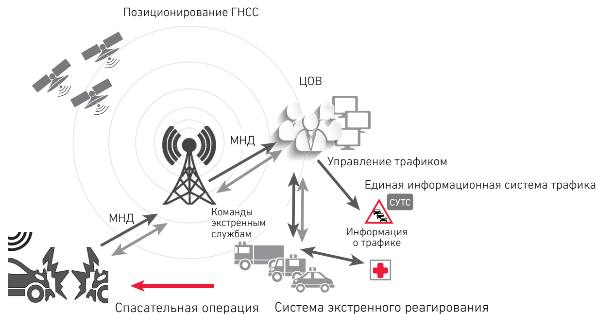
Рисунок 1. Типовая система экстренного реагирования при ДТП
