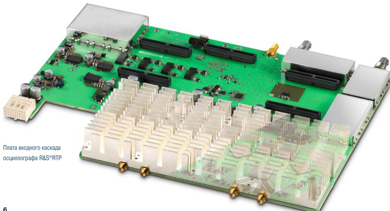
Плата входного каскада осциллографа R&S®RTP
