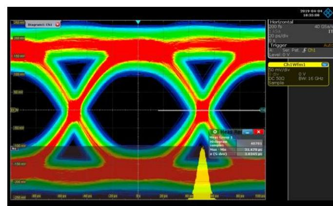
Функции запуска по шаблонам высокоскоростных последовательных шин и аппаратного CDR обеспечивают быстрое измерение глазковых диаграмм
