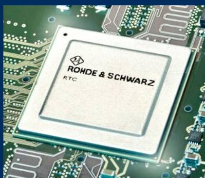
Микросхемы ASIC для обработки данных в R&S®RTP
