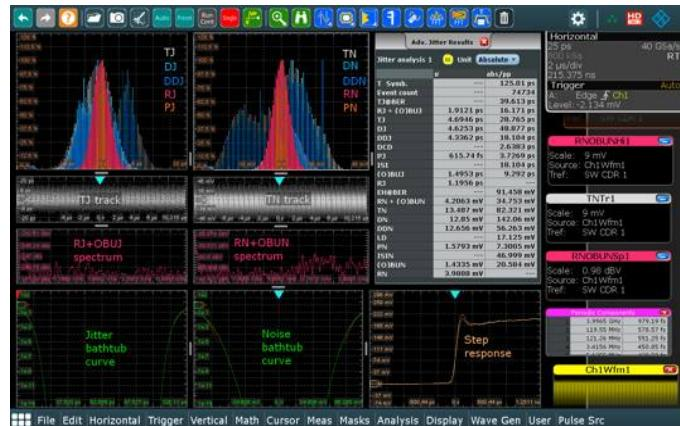
Отображение результатов измерения переходной характеристики, отдельных компонентов джиттера и шума на гистограммах, спектре, синтетической глазковой диаграммы и кривой интенсивности отказов по коэффициенту BER для сигнала PCIe Gen3 со скоростью 8 Гбит/с.
