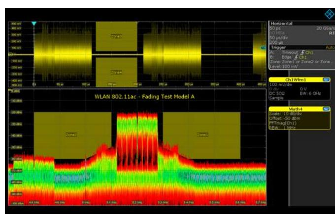
Запуск по сигналу WLAN IEEE 802.11ac в условиях заморозки с помощью функции зонального запуска
