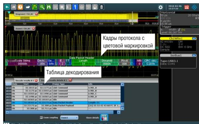
Понятное отображение декодированных данных на осциллографе и в таблице декодирования
