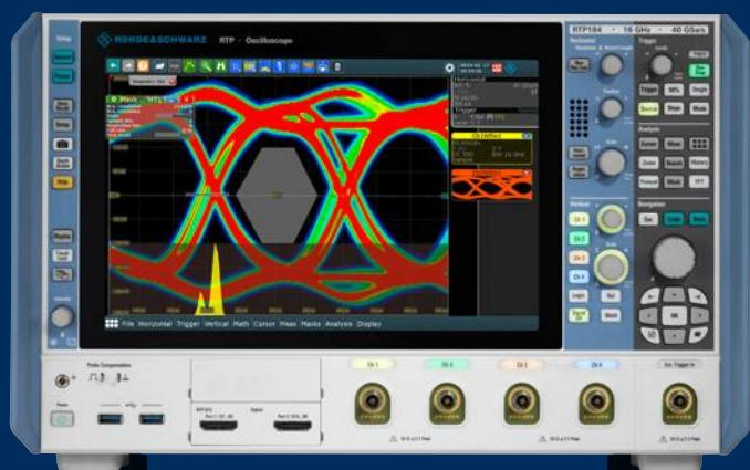
Передняя панель премиального исполнения осциллографа R&S®RTP
