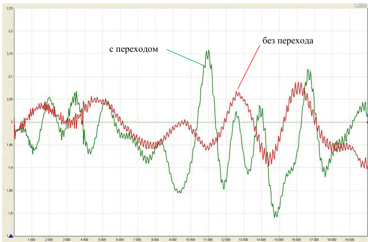
Рисунок 4.19 – Результаты измерений КСВН нагрузки (КСВН = 2,0)
