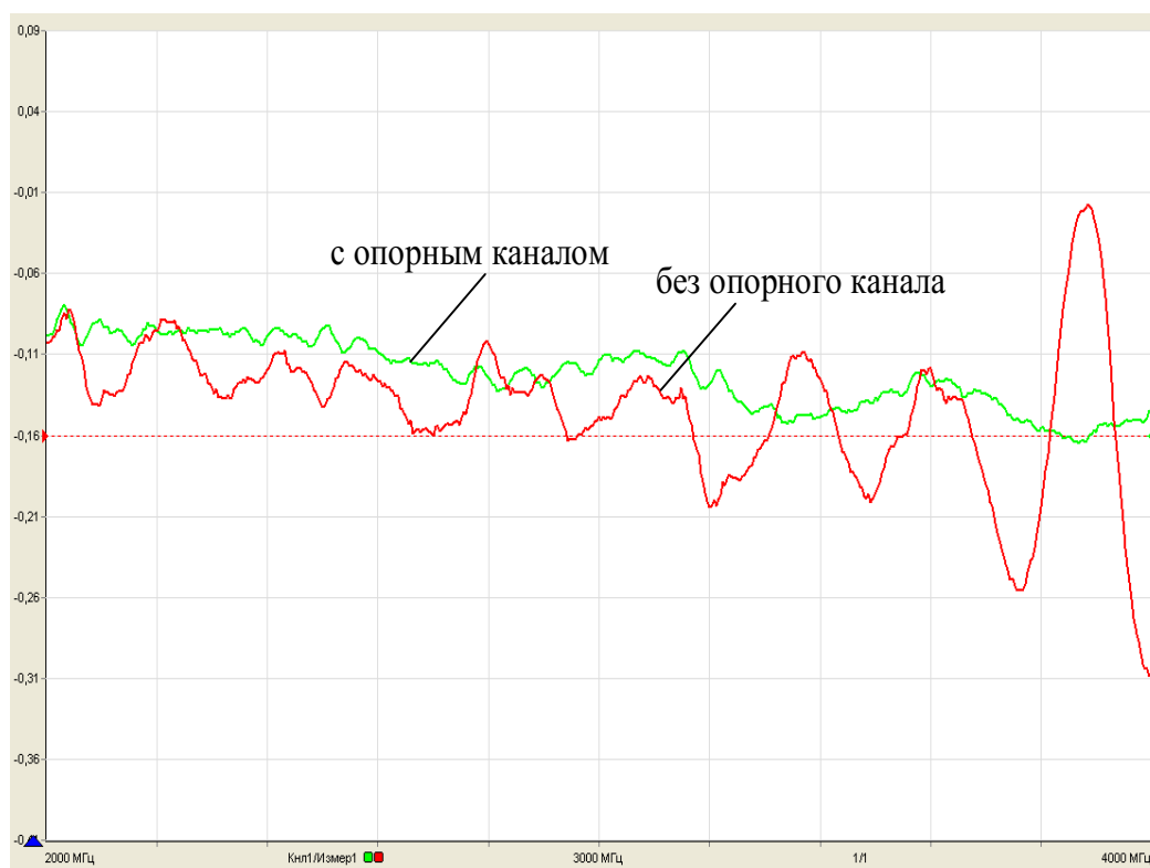
Рисунок 5.10 – Измерение модуля КП кабельной сборки
