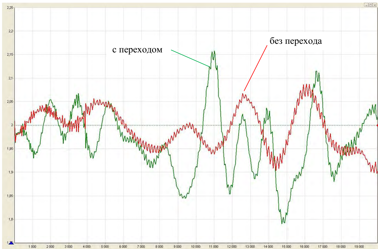
Рисунок 5.19 – Результаты измерений КСВН нагрузки (КСВН = 2,0)
