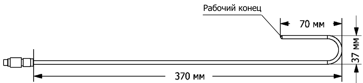
Рисунок Б.1 — Устройство термопреобразователя сопротивления ЛТА-ДВ
