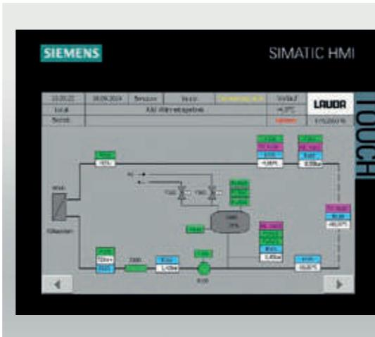
Система управления на основе ПЛК с сенсорной панелью 7" для интуитивного управления и обмена данными с системами управления производственным процессом
