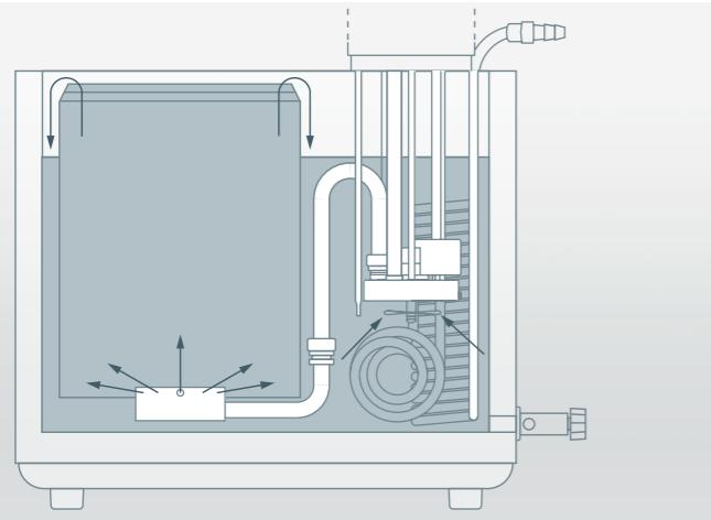
Постоянная глубина погружения благодаря калибровочной камере с принципом перелива
