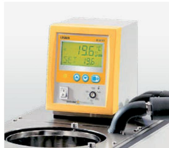
Постоянная глубина погружения благодаря калибровочной камере с принципом перелива
