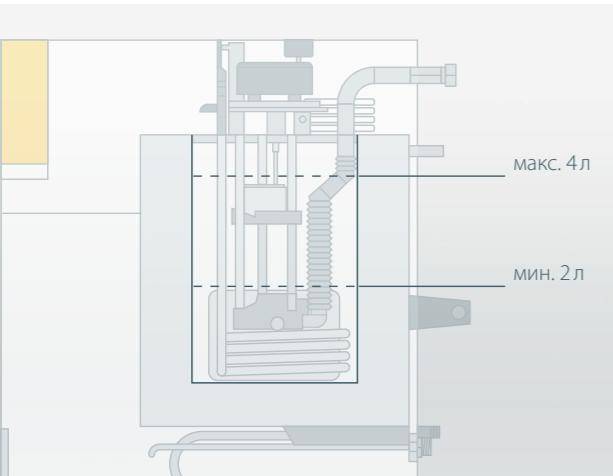
Малый объем наполнения и мощный насос Varioflex обеспечивают быструю смену температуры при низких эксплуатационных затратах и небольших расходах материалов
