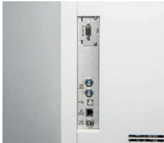
Интерфейсы USB, Ethernet и Pt100 в стандартной комплектации прибора, доступны другие интерфейсные модули
