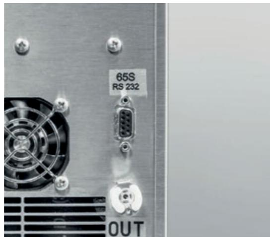
Интерфейс RS 232 в комплекте поставки для интеграции системы в процесс
