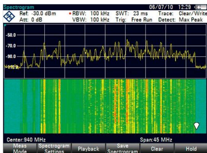
Анализ с помощью долговременной записи спектрограммы в ПО
