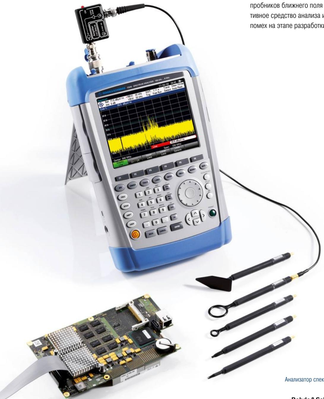
Анализатор спектра R&S®FSH с пробниками ближнего поля и ИУ
