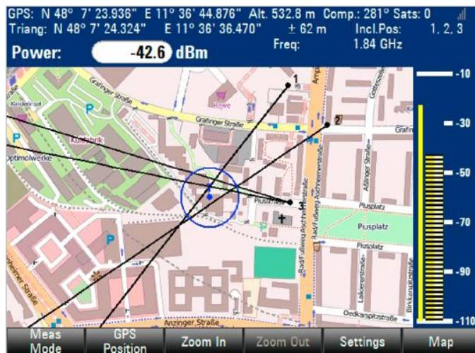
Индикация результатов с геопривязкой с помощью опции R&S®FSH-K16
