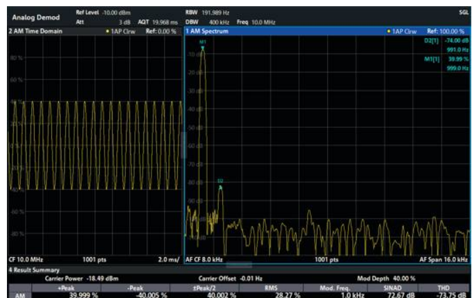
Результат измерения коэффициента THD для амплитудно-модулированного сигнала: первая гармоника сигнала модуляции подавлена на 74 дБ
