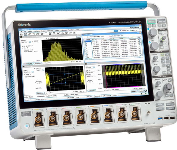
Рис. 28. Анализ импульсного сигнала на осциллографе MSO68B с помощью ПО SignalVu-PC
