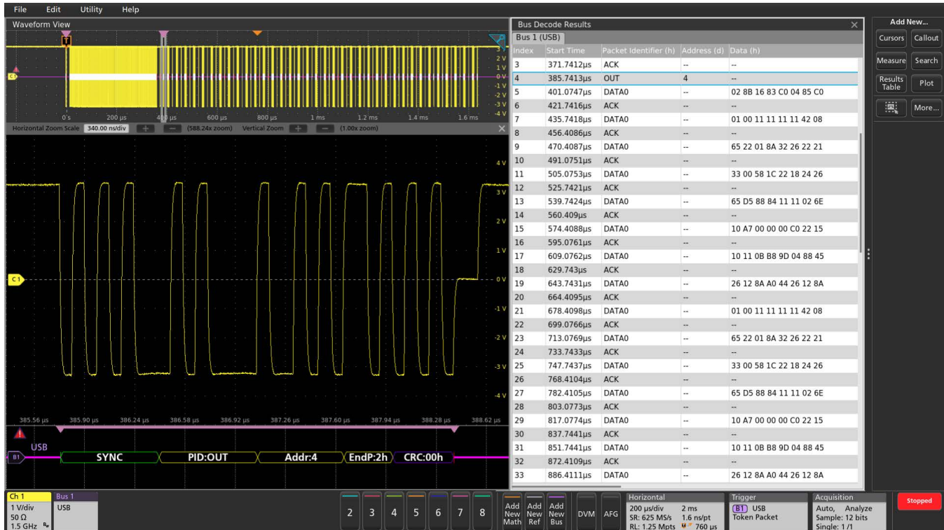
Рис. 24. Запуск по пакету высокоскоростной последовательной шины USB. На осциллограмме сигнала шины отображается декодированное содержимое пакетов, в том числе Start (Пуск), Sync (Синхронизация), PID (Идентификатор пакета), Address (Адрес), End Point (Конечная точка), CRC (Контрольная сумма), Data values (Значения данных) и Stop (Стоп), в то время как в таблице декодирования пакета представлено всё захваченное содержимое.
