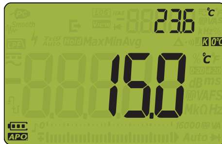
Рис. 2–25 Измерение температуры без компенсации влияния температуры окружающей среды
