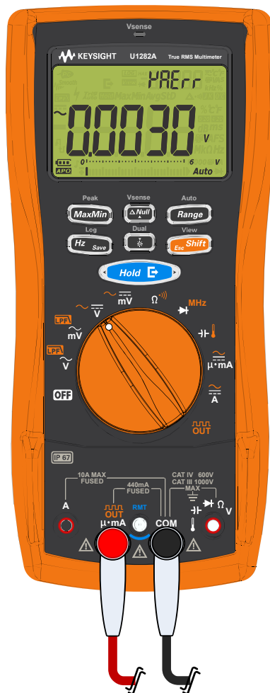
Рис. 1–4 Пример неправильного присоединения входных проводов к разъемам
