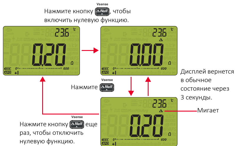
Рис. 3–3 Принцип работы нулевой функции
