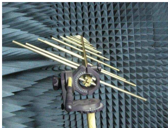
Фото 2. Антенна П6-122 на диэлектрическом штативе
