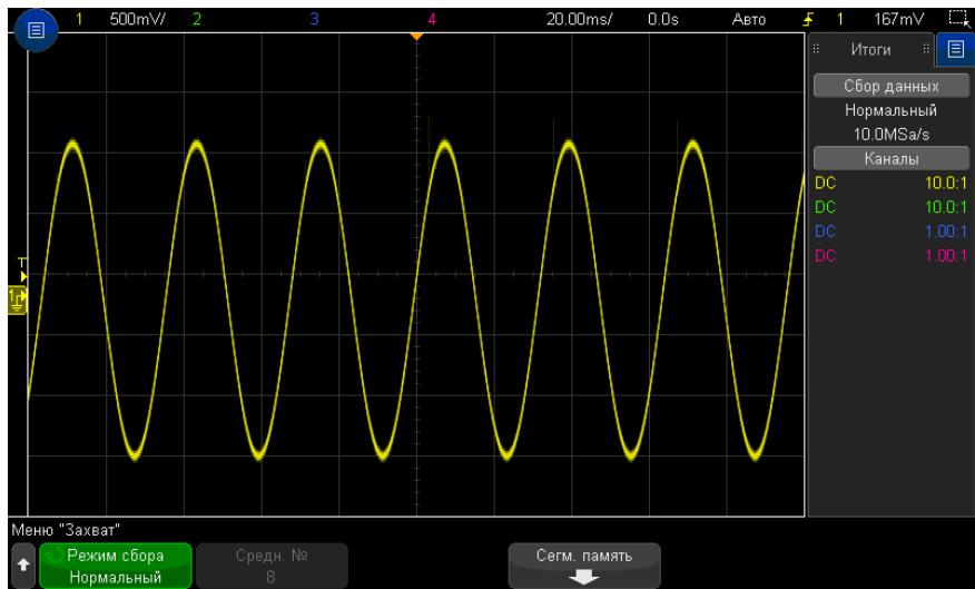
Рис. 37 Синусоида с импульсной помехой, нормальный режим
