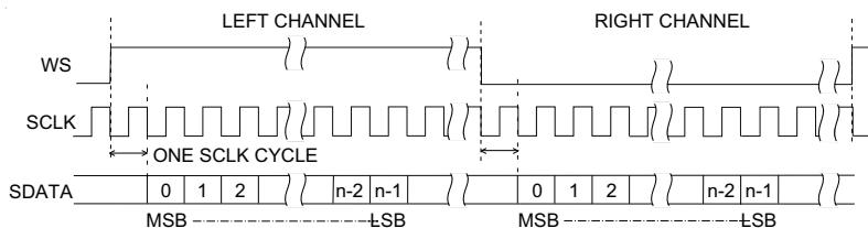
**12** Нажмите программную кнопку **Наклон SCLK** и поверните ручку ввода, чтобы выбрать фронт SCLK, по которому синхронизируются данные в тестируемом устройстве: передний или задний. Диаграмма на экране изменяется по мере выбора параметров.
