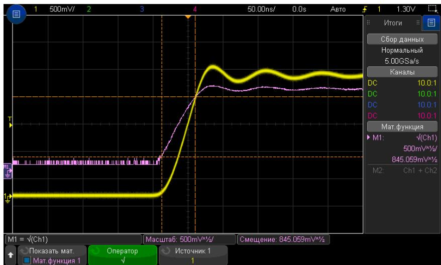
Рис. 11 Пример функции  $\sqrt{}$  (квадратный корень)
