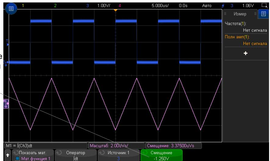
**Рис. 10** Интегрирование со смещением сигнала
