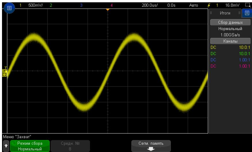
Рис. 39 Случайные шумы на отображаемом сигнале
