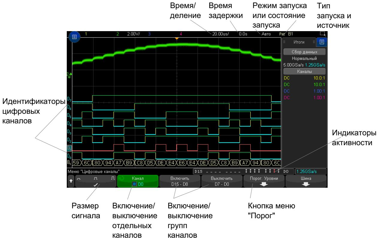
**Индикатор активности** Если включен какой-либо цифровой канал, в строке состояния внизу экрана будет показан индикатор активности. Цифровой канал может находиться в постоянно высоком (■), постоянно низком (■) или переключаемом логическом состоянии (↑↓).
