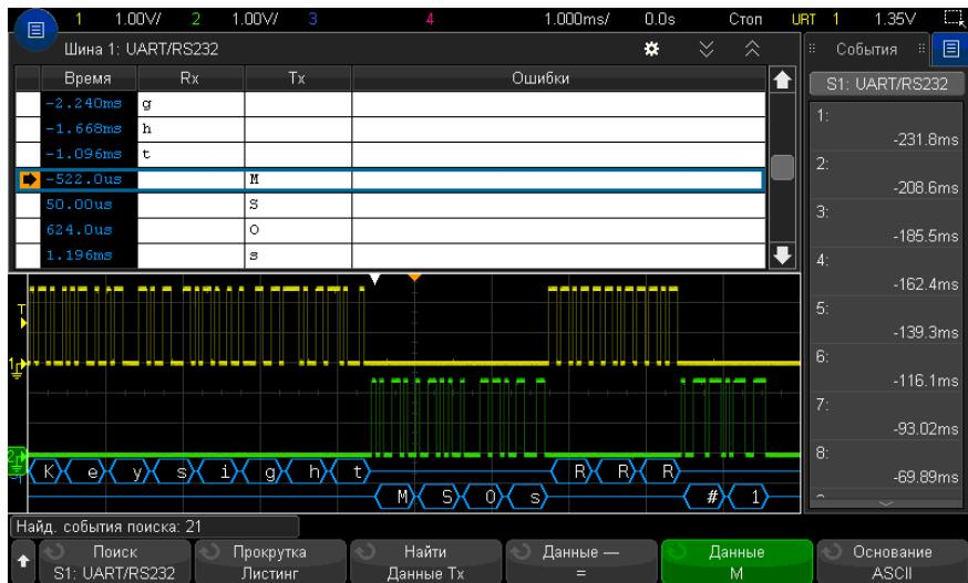
Каждый модуль последовательного декодирования позволяет находить связанные с его протоколом заголовки, данные, ошибки и т.д. См. следующие разделы:
