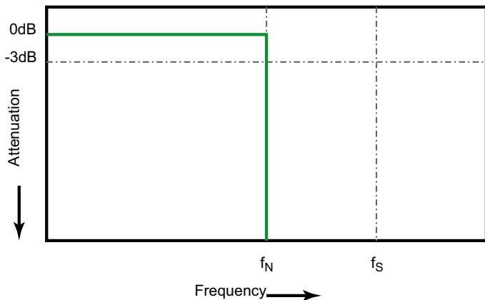
**Рис. 35** Теоретическая амплитудно-частотная характеристика
