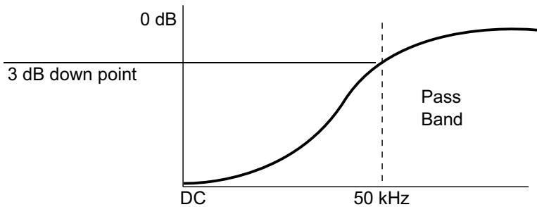
Низкочастотное заграждение устраниет из сигнала запуска нежелательные низкочастотные составляющие (например, частоты линии питания), которые могут создать помехи надлежащему запуску.
