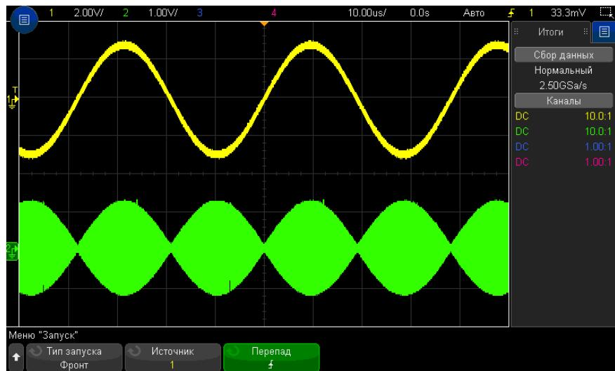
Рис. 26 Отображение амплитудной модуляции при яркости 100 /
