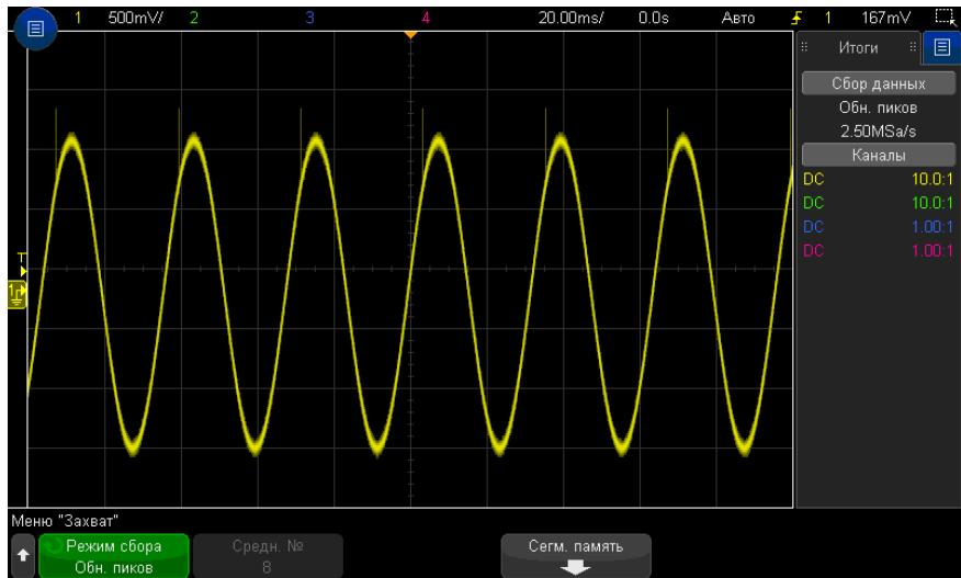
Рис. 38 Синусоида с импульсной помехой, режим обнаружения пиков
