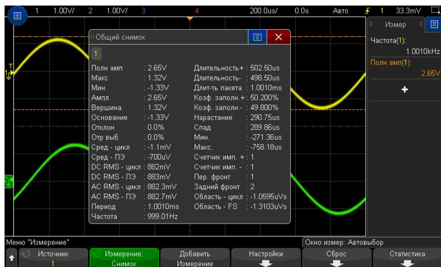
Можно также выполнить настройку для кнопки **[Quick Action] Быстрое действие**, чтобы при ее нажатии отображалось в сплывающем окне "Общий снимок". См. ["Настройка кнопки "\[Quick Action\] Быстрое действие""](#) на странице 369.
