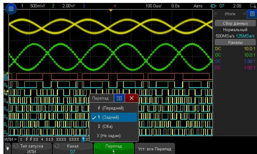
Если все каналы в режиме запуска по ИЛИ установить на X ("безразличное состояние"), то осциллограф не будет запускаться.
