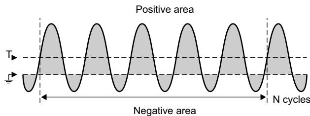
Изменение интервала измерения "Полный экран" позволяет измерить значение во всех отображаемых точках данных.
