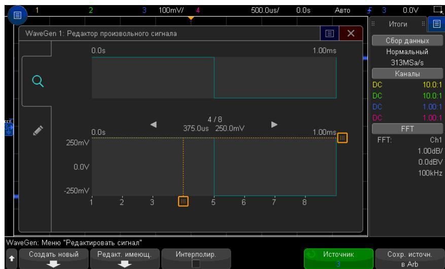
При открытии меню “Редактировать сигнал” отобразится определение имеющегося произвольного сигнала. Напряжение и время, которые отображаются на графике, являются параметрами ограничения. Они зависят от параметров частоты и амплитуды в главном меню генератора сигналов.
