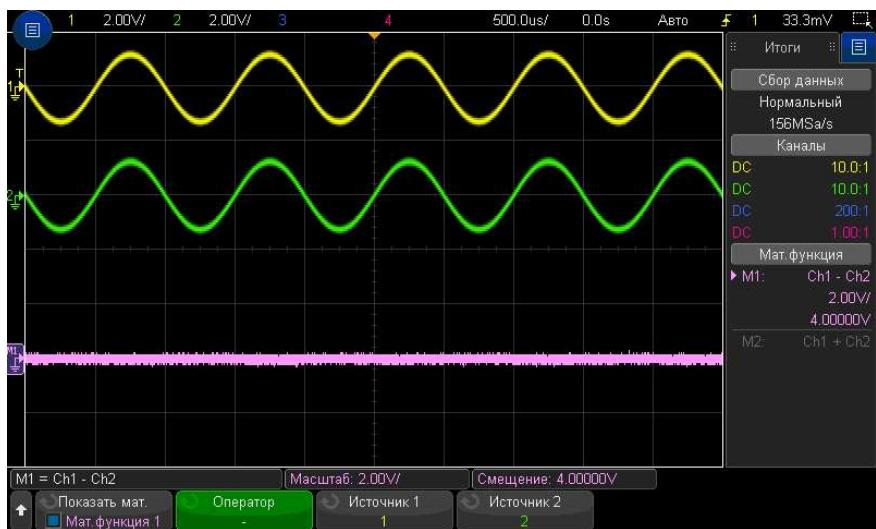
**Рис. 6** Пример вычитания сигнала канала 2 из сигнала канала 1
