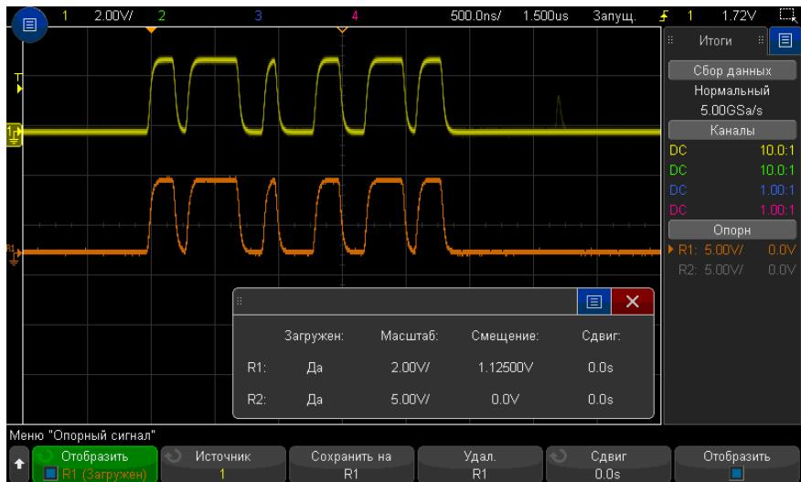
Только один опорный сигнал можно отобразить одновременно.
