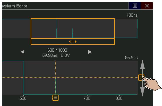
Чтобы выбрать область точек, выполните жест перетаскивания через верхнюю или нижнюю часть отображения сигнала:
