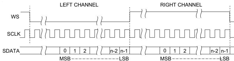
**11** Нажмите программную кнопку **Низкое значение WS** и поверните ручку ввода, чтобы выбрать, данные какого канала (левого или правого) обозначает низкое значение WS. Диаграмма на экране изменяется по мере выбора параметров.
