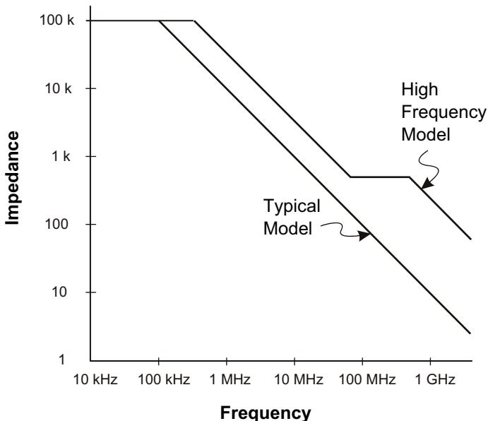
**Рис. 24** Зависимость импеданса от частоты для схем цепи пробников обоих моделей
