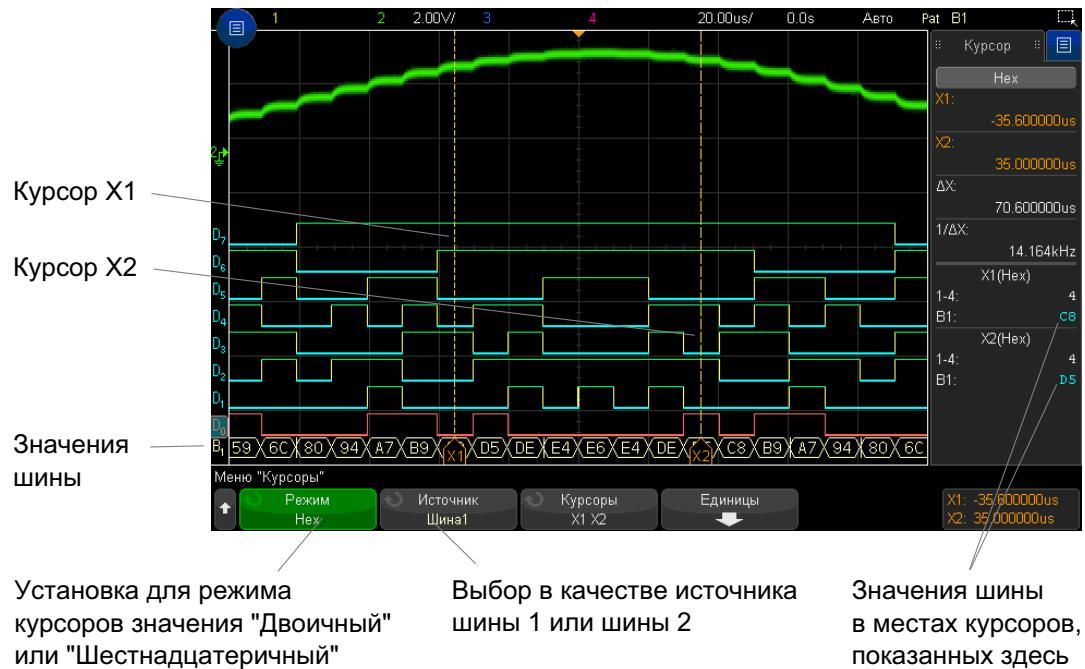
Отображение значений шин при использовании запуска по шаблону
