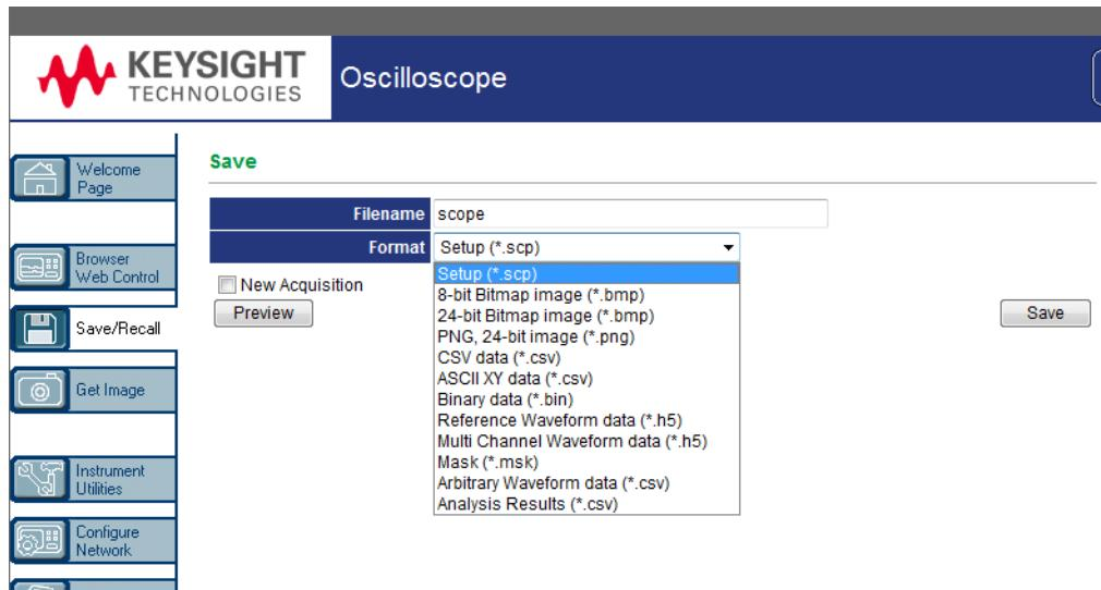
Для просмотра изображения текущего дисплея осциллографа можно нажать кнопку **Предварительный просмотр**. Перед предварительным просмотром можно запустить сбор данных, установив флажок **Новый сбор данных**.
