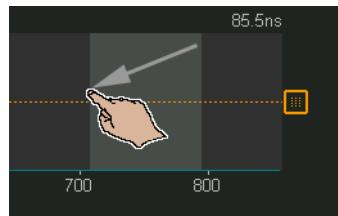
Для точной регулировки выбора области (или для отмены выбора) коснитесь вкладки редактирования и используйте средства управления **Выбранная область**:
