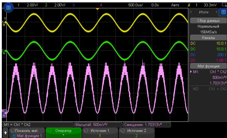
**Рис. 7** Пример умножения сигнала канала 1 на сигнал канала 2
