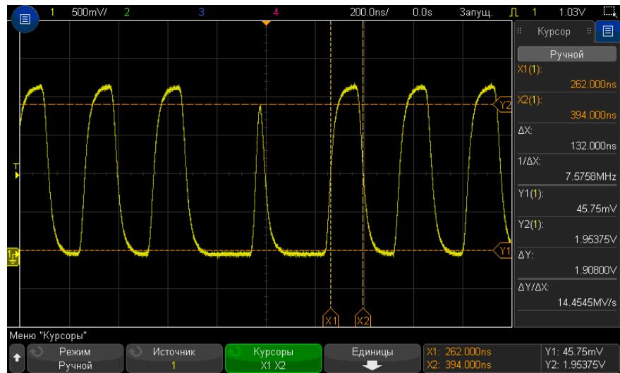
**Рис. 44** Измерение длительности импульса с помощью курсоров
