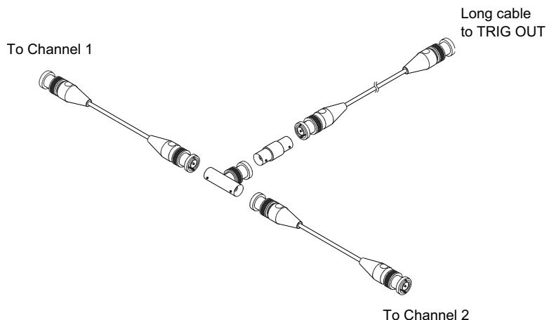
**Рис. 50** Соединение кабелей для пользовательской калибровки двухканального осциллографа
