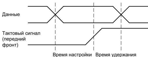
Один канал осциллографа используется для измерения тактового сигнала, а другой – для измерения сигнала данных.
