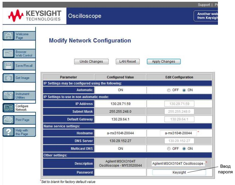
Чтобы получить доступ к осциллографу, защищенному паролем, в качестве имени пользователя необходимо указать IP-адрес осциллографа.
