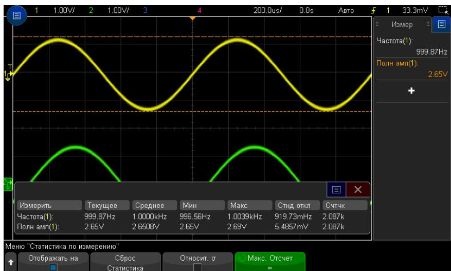
Канал источника измерения указан в кавычках после названия измерения. Например, **“Част(1)”** означает частотное измерение на канале 1.
