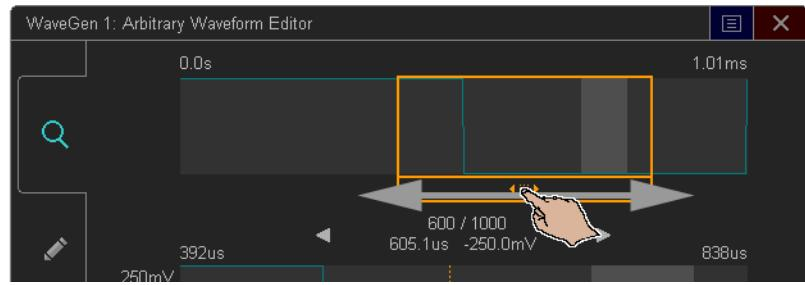
Для точного указания точки коснитесь стрелки для перехода к предыдущей или следующей точке:
