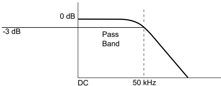
ВЧ-заграждение подходит для устранения из канала запуска высокочастотных помех, например от радиостанций, вещающих в диапазонах АМ или ЧМ, или от высокоскоростных системных тактовых сигналов.
