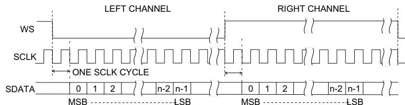
**Выравнивание по левому краю** – передача данных (сначала MSB) начинается от края перехода WS (без задержки в один бит, применяемой в стандартном формате).
