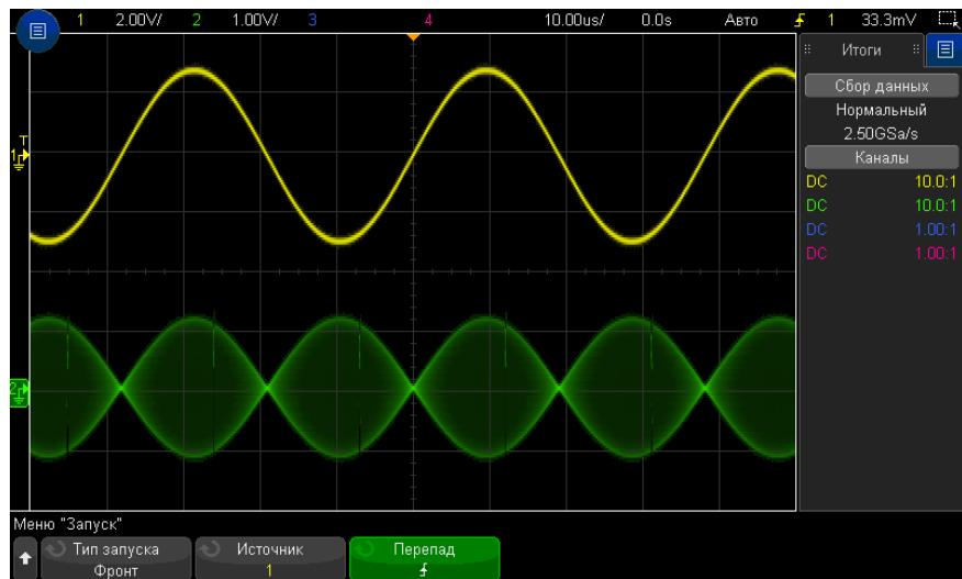
Рис. 27 Отображение амплитудной модуляции при яркости 40 /
