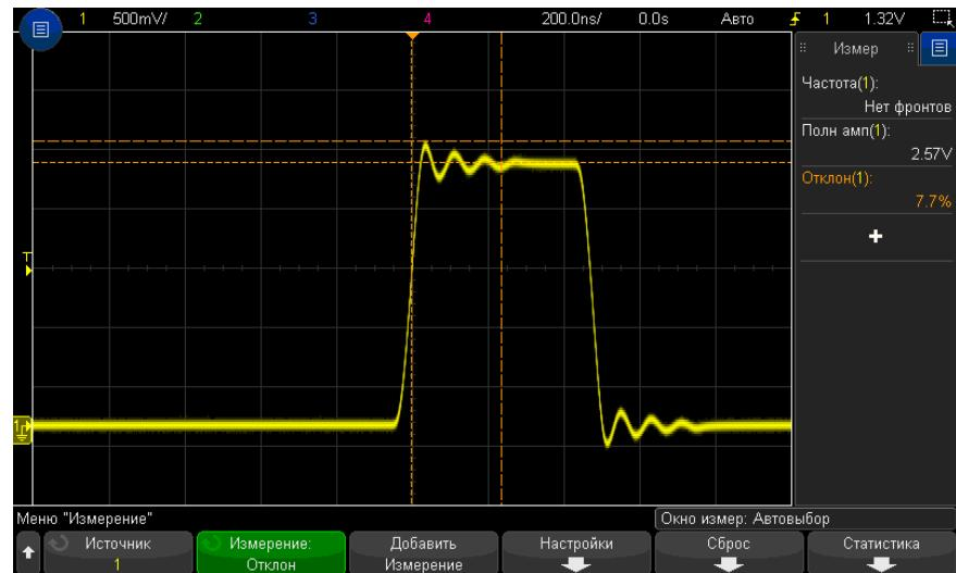
**Рис. 48** Автоматическое измерение отклонения от установленного значения
