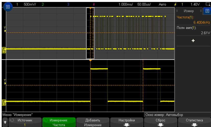
**Рис. 49** Локализация события с целью измерения частоты
