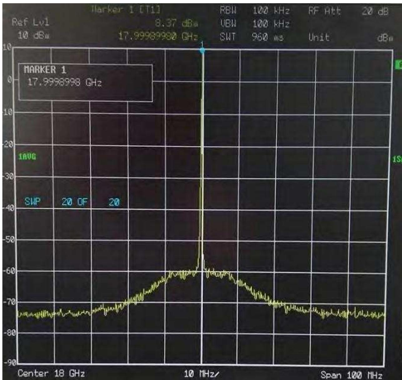
Спектр выходного сигнала 18 ГГц (SPAN 100 кГц)
