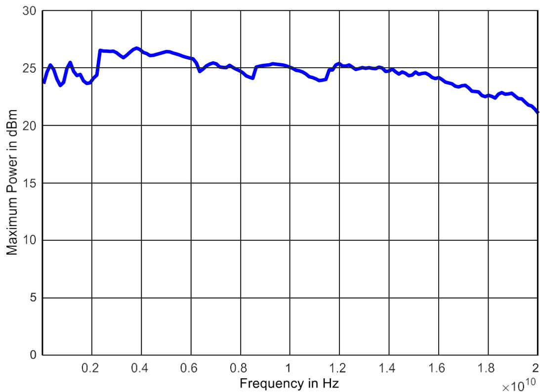
Максимальная выходная мощность RFSU40 тип.
