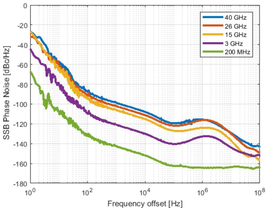
Спектральная плотность фазовых шумов, в отстройках 1 Гц до 100 МГц, стандартная комплектация. (Опция ULN).
